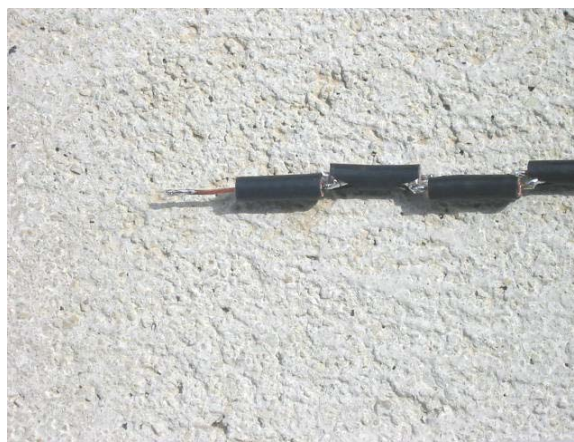
foto del "cimino" ovvero l'ultimo spezzone di sezione di cavo coassiale RG 213
