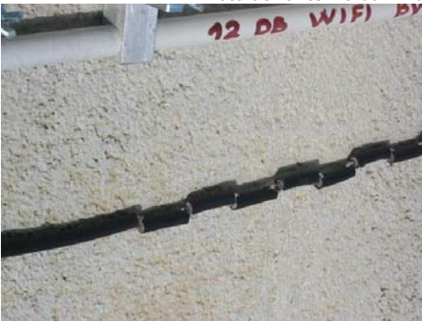
foto dell'antenna da 11 dB pronta per essere incapsulata nel rivestimento di protezione
