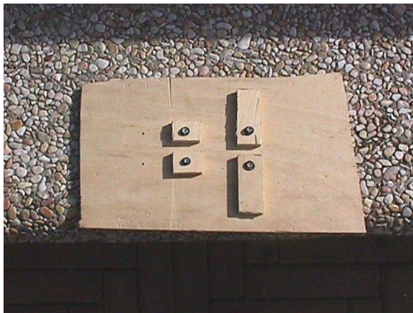
foto della tavolozza di legno con le guide per la miglior saldatura degli spezzoni
