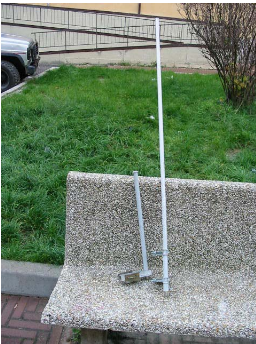
foto dei due prototipi dell'antenna., a sx da 5dB e a dx da 11 dB
